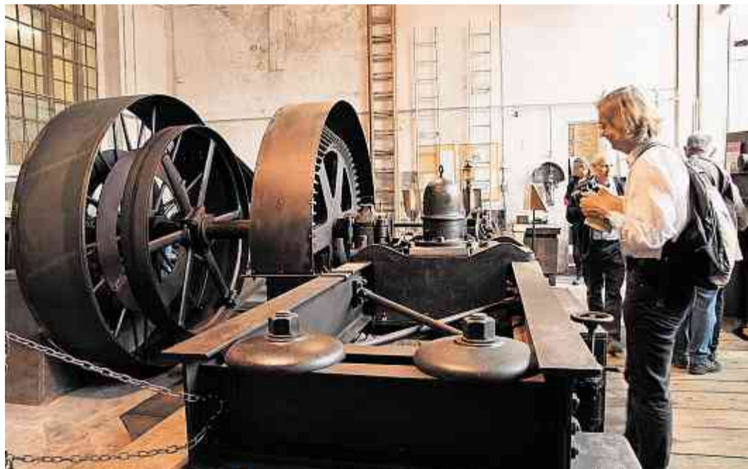
Die älteste Turbine wurde früher für mechanische, später für elektrische Energiegewinnung genutzt.
